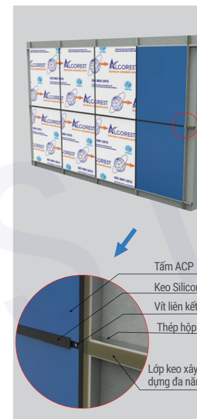
Hình 5.1a: Thi công tấm ghép mí và soi rãnh bản vít
